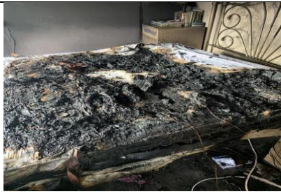
Fotoğraf 2: Yangına yol açan bir elektrikli battaniye ve yatağın son hali
