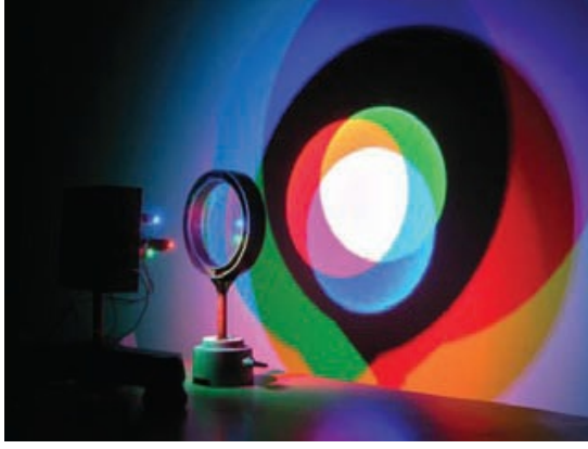
Şekil 11: 3 ana renkte LED ile ara renklerin elde edilmesi
