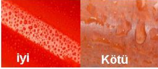
Şekil 13: Su Püskürtme Değerlendirmesi
