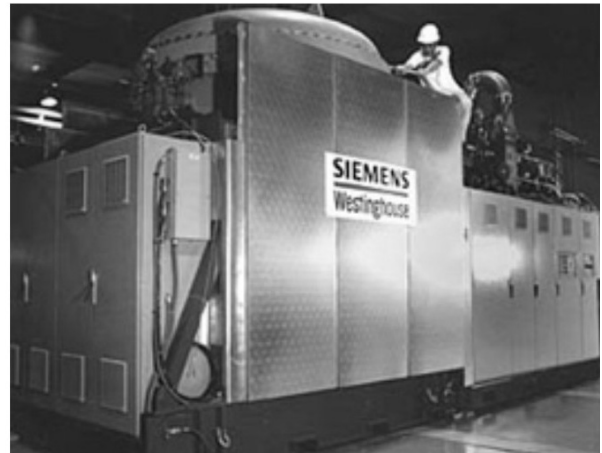
Şekil 1. Gaz türbinli, yakıt hücreli kojenerasyon sistemi
