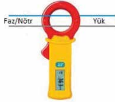
Şekil 4- Tek fazlı besleme için ölçüm yöntemi
