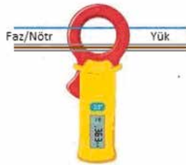
Şekil 6- Nötr'lü üç fazlı besleme için ölçüm yöntemi
