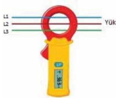
Şekil 5- Üç fazlı besleme için ölçüm yöntemi
