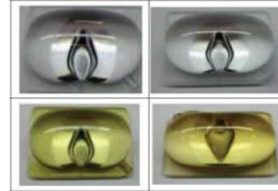
Resim 6: Lenslerin UV/65°C 6000 saat kullanım sonrası şartlarda durumu
