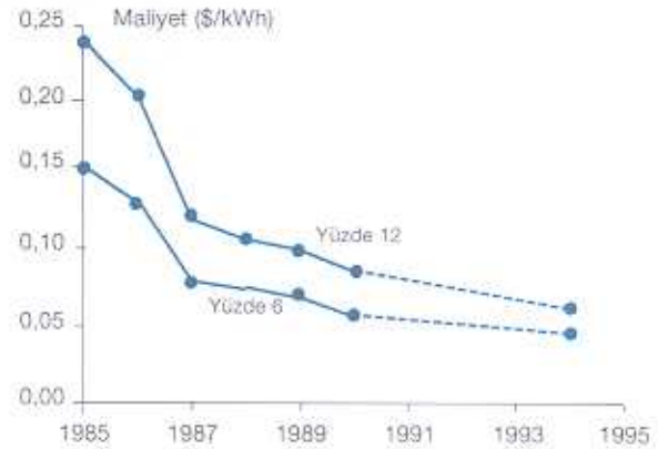
ŞEKİL 1: Kaliforniya'daki rüzgar türbinlerinden üretilen elektriğin maliyetinin düşüşü; veriler 1994 için (1,2) tahmin ediyor. (a)Ortalama rüzgar enerji yoğunluğu >450watt/m 2 , Kaliforniya'da geçilen için tipik değer (b) İşletim ve bakım masrafları (2)'den, (c.) U.S. rüzgar gücü'nün (Windpower) dosyalarına dayanarak, Kaliforniya Enerji Komisyonu'nun U.S. rüzgar gücünün 33MV-S değişken hızlı türbininin 1994 yılı maliyet tahmini, U.S. rüzgar gücü tarafından işletme ve bakım artı toprak kira bedeli kWh başına 0.0104 dolar olarak belirtmiş. Saha deneyimlerinden edindiğimiz bilgilere göre işletme ve bakım maliyetlerinin şu andaki endüstriyel averaj olan kWh başına 0.01 dolar seviyesinin altına inmesi bekleniyor. Değişken-hızda çalıştırmanın en büyük avantajı türbin parçalarının üzerindeki stresin ve metal yorgunluğunun azaltılması ve bunun sonucu olarak bakım masraflarının azalmasıdır.
