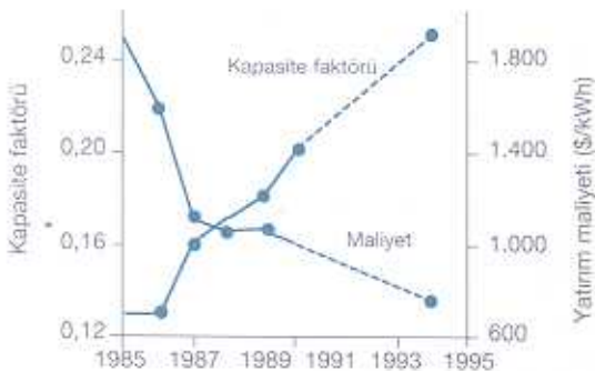
ŞEKİL 2: Rüzgar türbini kullanımı; şekilde kapasite faktörü olarak gösterilmiş; ortalama güç çıkışının rated (reyiç) güç çıkışına oranı ve Kaliforniya'daki rüzgar türbinleri için gerekli alt yapı yatırım maliyeti. U.S. Rüzgar gücü'nün (Windpower) dosyasına dayanarak, U.S. Rüzgar gücü'nün 33MW-S deyişken hızlı türbininin 1994 yılı maliyet ve kapasite faktörü tahmini. 1990'daki kapasite faktörü Kaliforniya'daki tüm rüzgar çiftlikleri için ortalamadır. Sadece Altamont Geçidi'ndeki artık eskimiş makinaların kullanıldığı rüzgar çiftliklerinin bulunduğu alan için bu değer 0,24, San Geronio Geçidi için kapasite faktörü 0,24 ve Tehachapi Geçidi için 0,19 (6).
