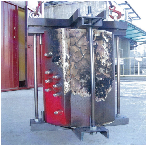
Şekil 7. F1 sınıfına uygunluk testi sonrası
