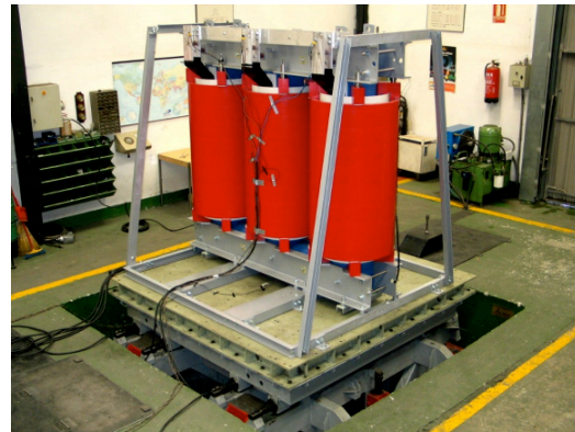
Şekil 3. 1600kVA transformatör sismik dayanım testinde
