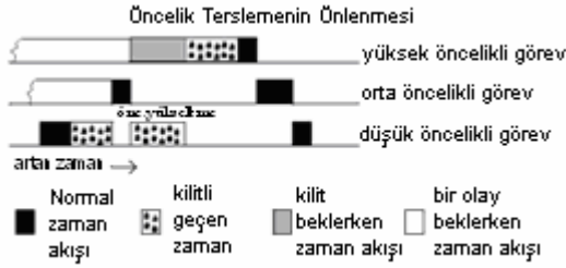
Şekil 10 Öncelik Kalıtılama mekanizması ile öncelik terslemenin önlenmesi
