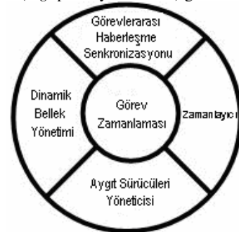
Şekil 2 Gerçek zamanlı işletim sistemi tarafından sağlanan temel servisler
