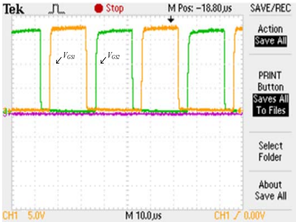
Şekil 9: İki kat sarmaşık dönüştürücüdeki güç anahtarlarına ait kontrol sinyallerinin zamana göre değişimi
