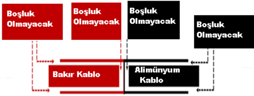
Şekil 9: Aliminyum Bakır Birleşme Noktalarındaki Yangın Sebepleri (Kaynak: Prof. Dr. O. Sevaioğlu)
