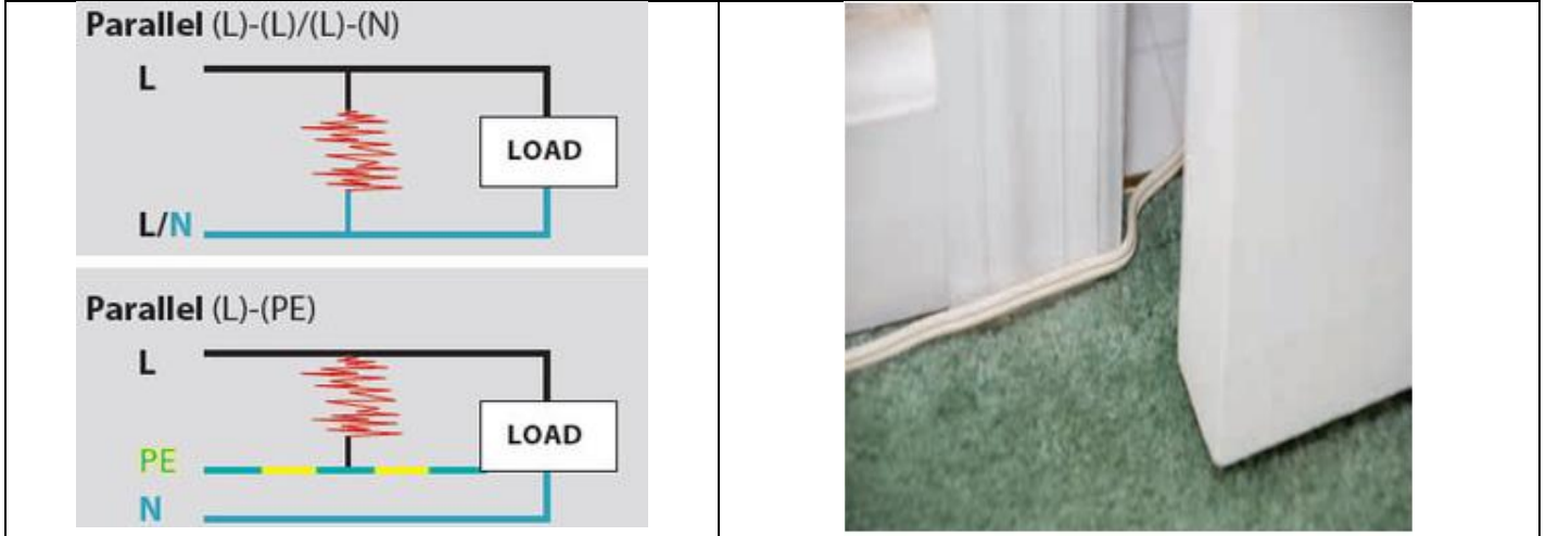
Şekil 5: Faz –nötr Kablonun Sıkışması İle
