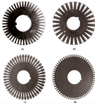
Şekil 4. NEMA tasarım sınıfları için rotor geometrileri [14]
