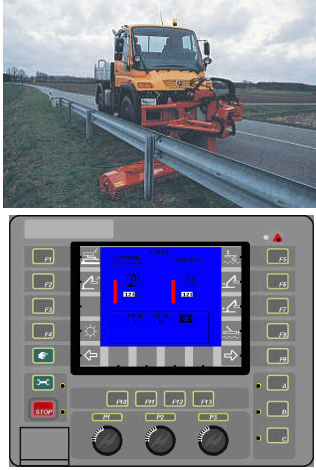
Şekil 3. RSM13: Yol Kenarı Yüzey Biçme Makinesi ve Yönetim Uçbirimi.
