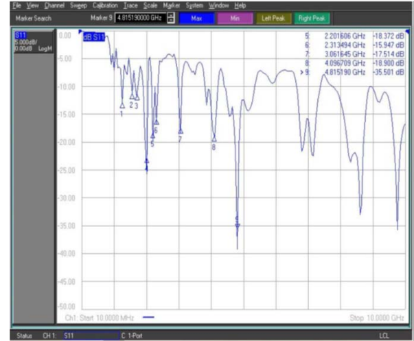
Şekil 6 Gerçeklenen LPDA antenin network analizörde |S_{11}| ölçüm sonucu
