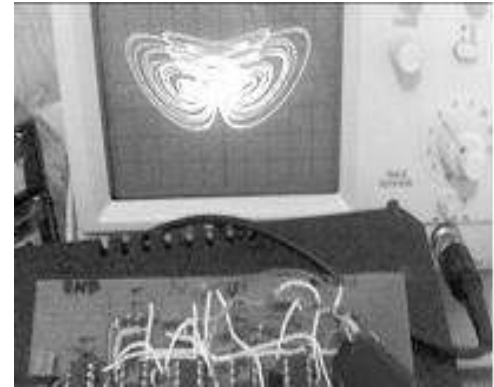
Şekil 4. Yeni kaotik sistemin elektronik devre şeması ve elektronik devre gerçekleştirilmesi
