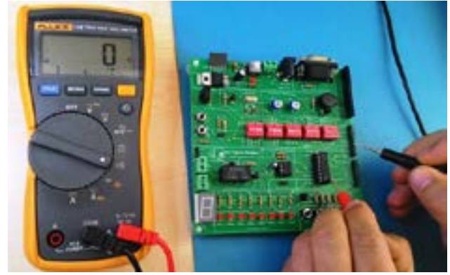
Resim 3.5. PIC16F628A pinlerinin PCB de irtibatlı olduğu header pinlerini belirleme.
