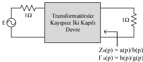
Şekil 1: Band geçiren devrenin kaskad kompozisyonu.
