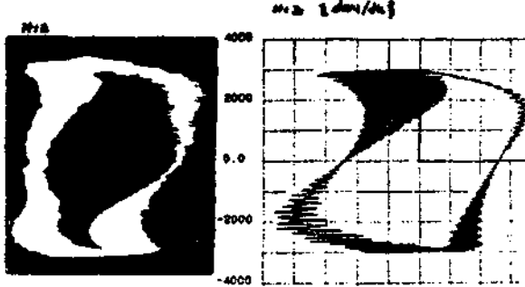
Şekil 5.a>Daaeyssel,b>Hesaplanan n.M=f<t> Şekil 5 de 9019e sargı Urifudı» kontrol edilerek <v* =V2 160Sin<wt> v,=V2 12Sin<wtl<, -90" S • S +90") elde edilen, deneysel ve hesaplanan özgeçiriler verilmektedir.
