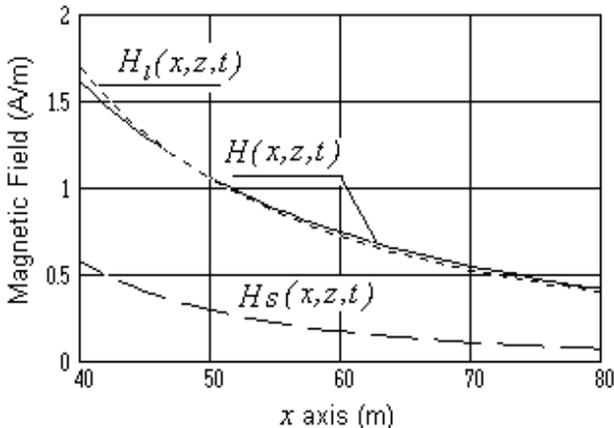
$H_s(x,z,t)$  ( $i(t)=700\sin\omega t$  A,  $il(t)=565\sin\omega t$  A,  $d=14$  m,  $z=-15$  m,  $h=7$  m,  $t=0$ ).
