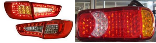
Resim 1. Piyasada hali hazırda bulunan ve tamamen LED kullanılmış arka stop grubu
