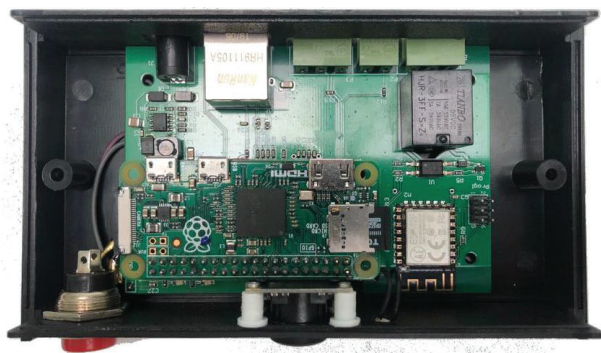
Şekil 4: Akıllı Pano Kontrol Kartının Donanım Yapısı.
