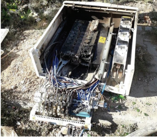
Şekil 1: Sabotaj Girişimi Sonucu Tahrip Edilen ASOP.
