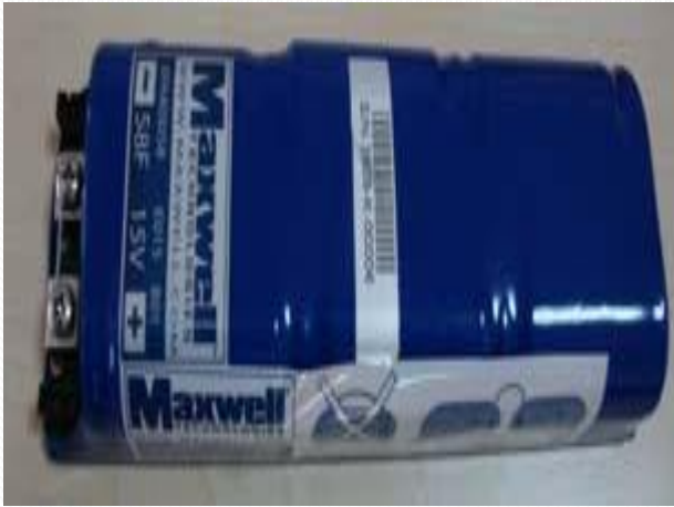
58 F kapasitesi ile 15 V ultra-kapasitör paketi
