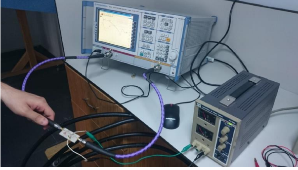
Şekil 14: Üretimi yapılan kuvvetlendirici devresinin ölçüm düzeneği
