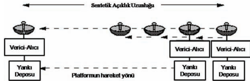
Şekil 1. Sentetik açıklık radarlarda sentetik açıklığın oluşturulması.
