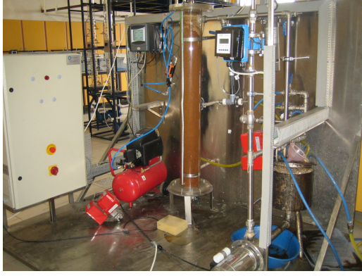
Şekil 1: Kullanılmakta olan yüksek performanslı membran biyoreaktör.
