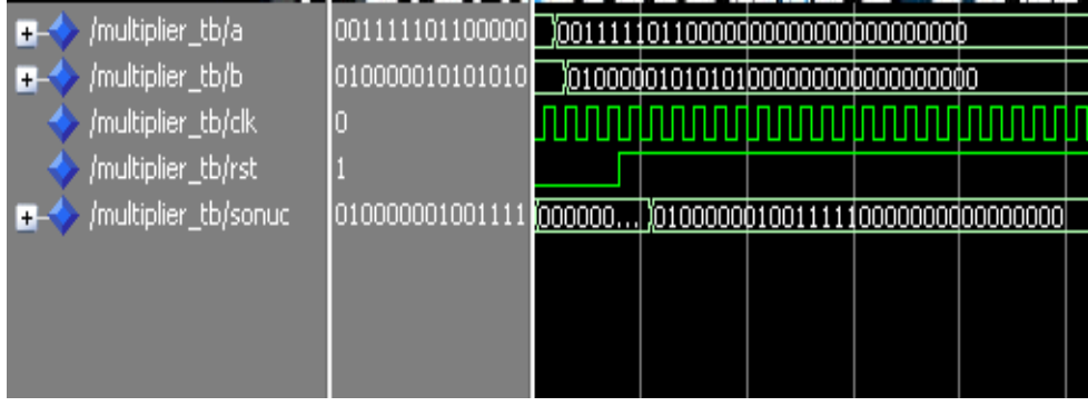
Şekil 6.8 Tasarlanan çarpma bloğunun simülasyon çıktıları
