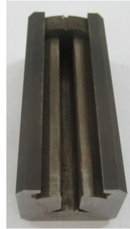
Şekil 14: Segment saclarını bir araya getirmede kullanılan master
