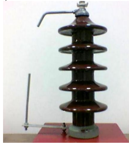
Şekil 3. Deneylerde kullanılan ark boynuzları ve 36 kV'luk transformatör tipi geçit izolatörü.
