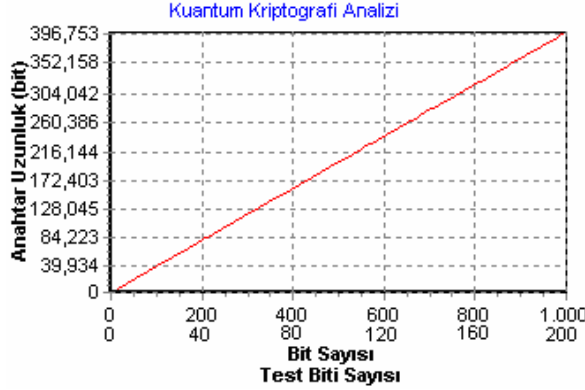
Şekil 8. Test bitleri kullanılması durumunda elde edilen anahtarların uzunlukları
