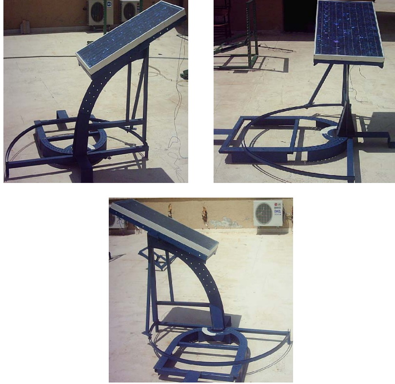
Şekil 2. İki eksende güneşi takip edebilen sistem sehpa
