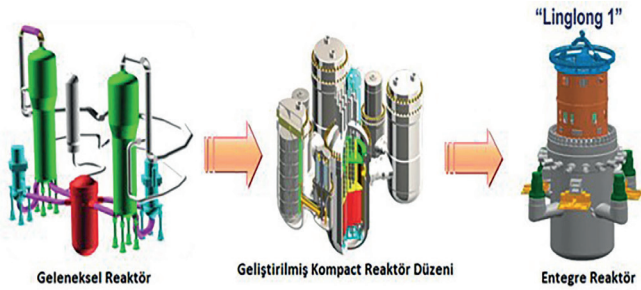
Şekil 3. Tam bağlantısız olarak tasarlanmış entegre küçük basınçlı hafif su reaktörü (nucleus.iaea.org)
