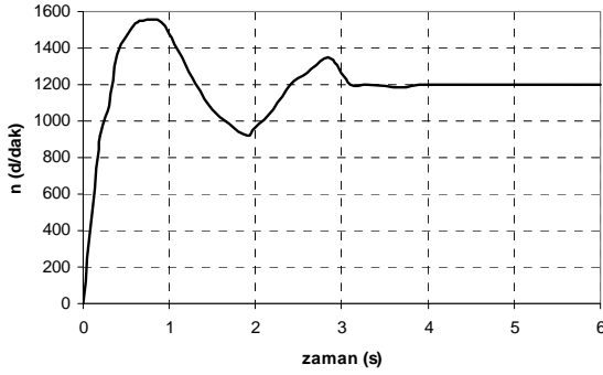
Şekil 19 ARM sürücünün n=1200 d/dak referans hız yüksüz durumda kapalı çevrim hız kontrolünde ölçülen hızın değişim grafiği.
