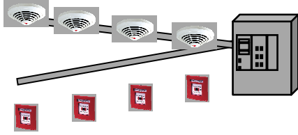
Şekil 3.2 Dal şeklinde çalışan yangın algılama sistemi
