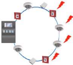
Şekil 3.3 Kısa devre oluşmasıyla, devre dışı kalan izolatörsüz elemanlar
