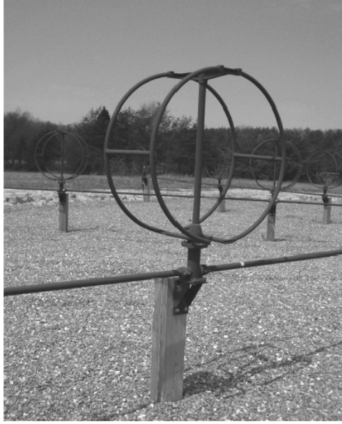
Şekil 8.7: Anteni sistemin bir parçası durumuna getirmek amacıyla hava hızında iletim hatlarıyla Direğe monte edilmiş Hermes Aktif Çerçevesi.
