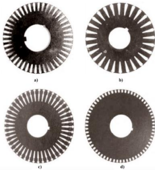
Şekil 4. NEMA tasarım sınıfları için rotor geometrileri [14]
