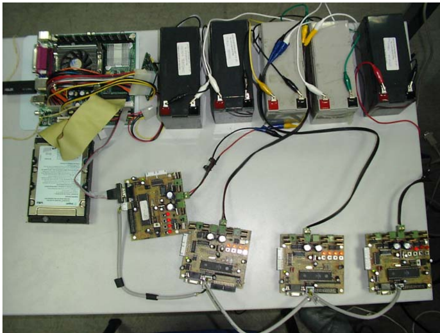
Şekil 6: Elektronik aksamın bütünü (bilgisayar+motor kartları )
