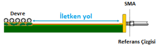
Şekil 4: Nesne çıkarma (de-embedding) yöntemi ile iletken yolun etkisinin silinmesi
