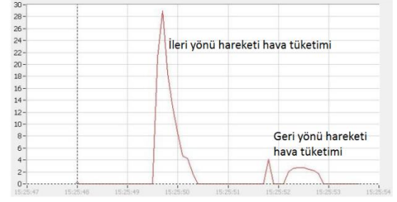
řekil 11. İleri yönü 4.5bar, geri yönünde basınç regülatörü ile 2 barda hava tüketimi [4]
