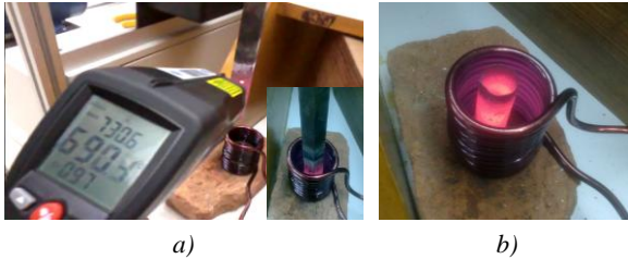
Şekil 35 a)Krom-Nikel parçanın indüksiyon ile ısıtılması, b)demir boru parçasının indüksiyon ile ısıtılması
