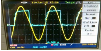
Şekil 13 Paralel rezonans gerilimi (CH1 –Sarı – (5V/div) ve MOSFET gate-source gerilimi (CH2 – Mavi - (5V/div))
