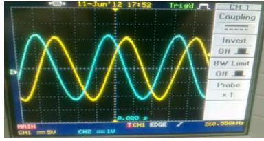
Şekil 14 Bobin akımı (CH1 –Sarı – (5V/div)x(6A/V)) ve paralel rezonans gerilimi (CH2 – Mavi – (1V/div)x(140))
