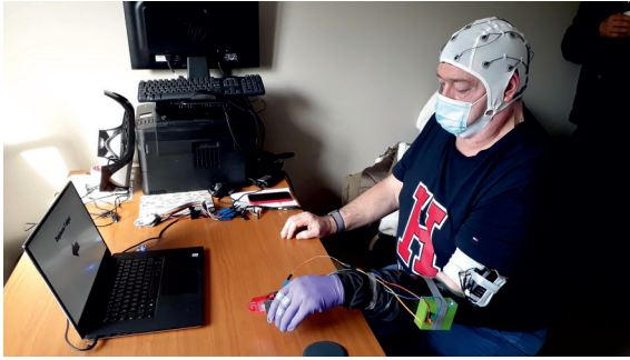
Şekil 3: Ampute bir protez kullanıcısı BMA tabanlı sensorimotor kontrollü protezin ilk prototipini deneyler sırasında test ederken.
