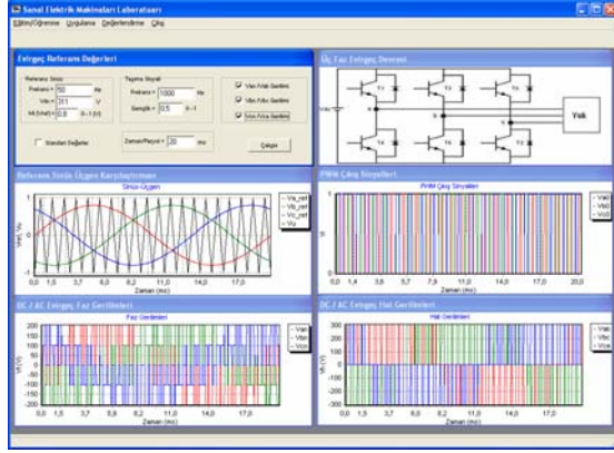
Şekil 3.3. DC/AC Evirgeç faz ve hat gerilimlerine ait dalga şekilleri
