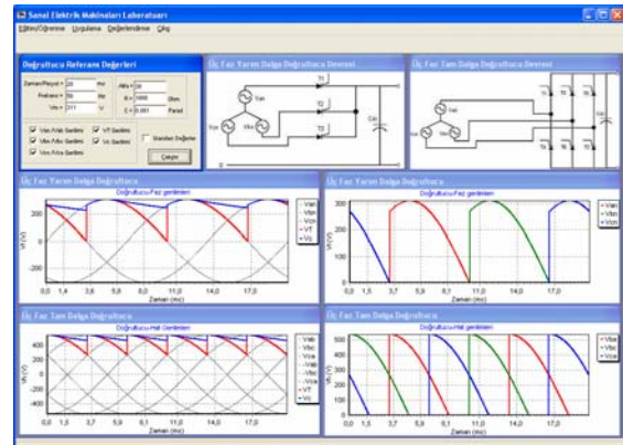
Şekil 3.2. Üç fazlı yarım ve tam dalga doğrultucu için benzetim sonuçları
