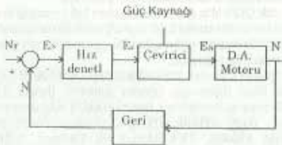
ŞEKİL 1 : Kapalı Çevrim Hız Denetim Sistemi Blok Diyagramı
