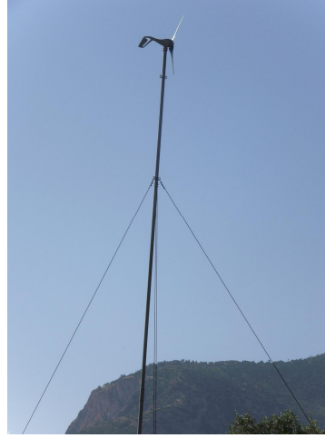
Şekil 3. 400W gücünde rüzgar türbini
