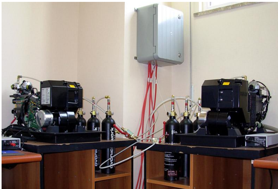
Şekil 2. 2.4kW gücünde yakıt pili grubu
