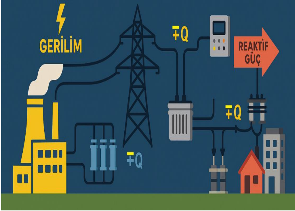
Şekil 43. İletim Sistemlerinde Gerilim Kontrolü
