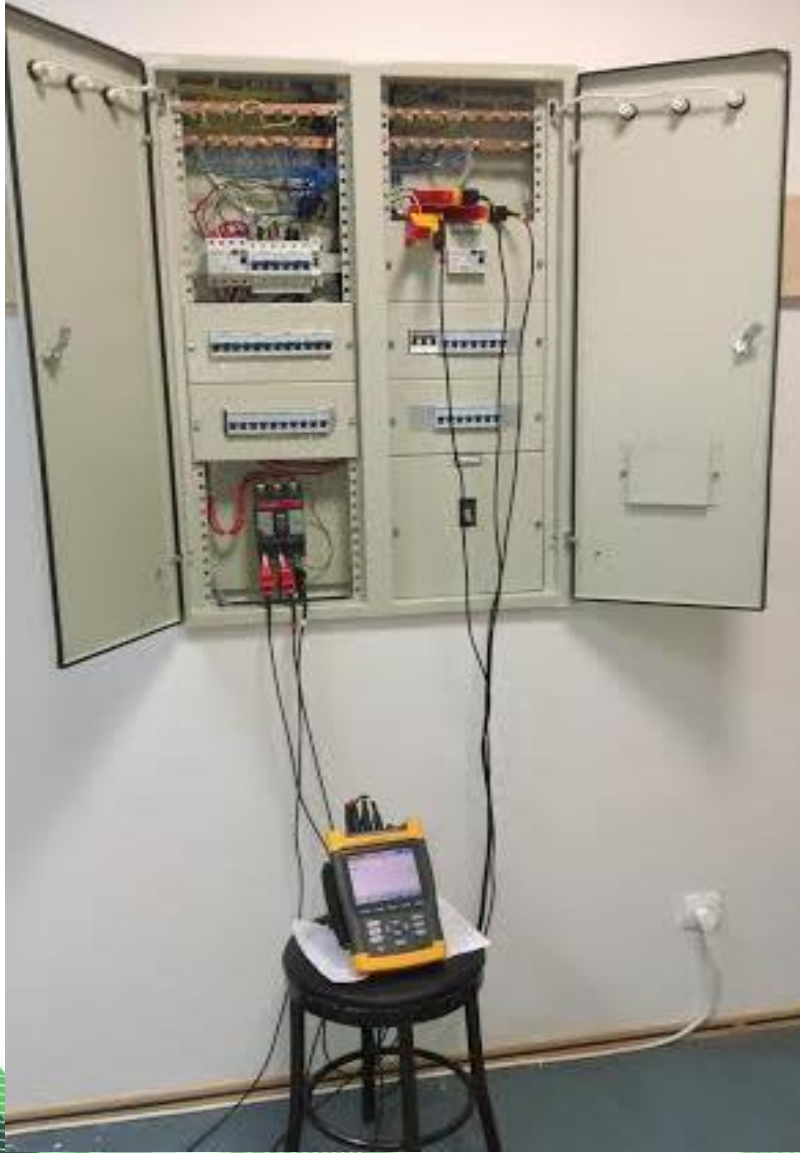
Şekil 5. Fluke 434 güç analizörü ile ölçüm.
