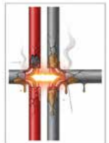
Şekil 2: Seri ve Paralel Ark Hatalarının Şematik Gösterimi
