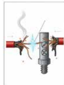
Şekil 2: Seri ve Paralel Ark Hatalarının Şematik Gösterimi
