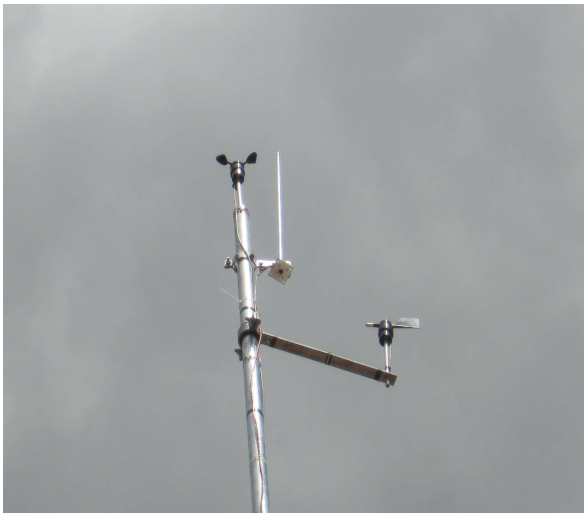
Şekil 2. Ölçüm sisteminin anemometre ve yön sensöründen oluşan kısmı
