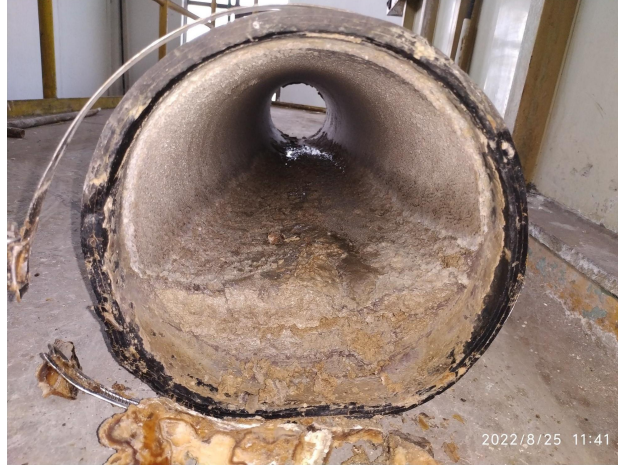
Şekil 2.5: Asit-Baz Birleşimi Kaynaklı Takanmış Boru
