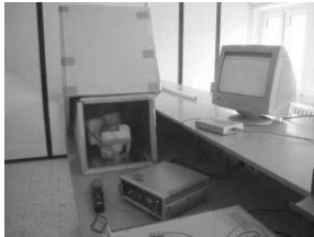
Şekil 1 Oluşturulan eşdeğer sıvı içerisinde sıcaklık artış ölçümünün yapıldığı deney düzeneği
