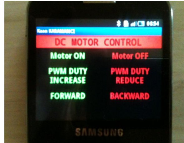
Şekil 16: Motor kontrolünü gerçekleştiren butonların bulunduğu ikincil ekran
